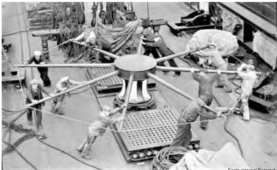
Tripulação trabalhando no cabrestante do USS CONSTITUTION. Antes da mecanização a bordo, todo o trabalho era feito à força de braços e ao som de cantares de trabalho.
